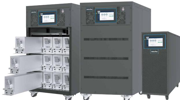
Моноблочные ИБП ИМПУЛЬС серии ФОРА мощностью от 10 до 100 кВА выполнены по технологии двойного преобразования энергии (онлайн) и предназначены для максимальной защиты критичной нагрузки от любых проблем с электропитанием - от различных помех до полного пропадания напряжения питающей сети. ИБП серии ФОРА поддерживают возможность резервирования N+1 для защиты критически важных нагрузок.
